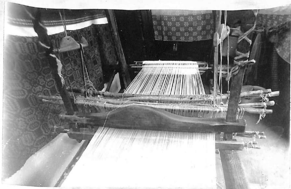
Тканье холста на горизонтальном ткацком стане
