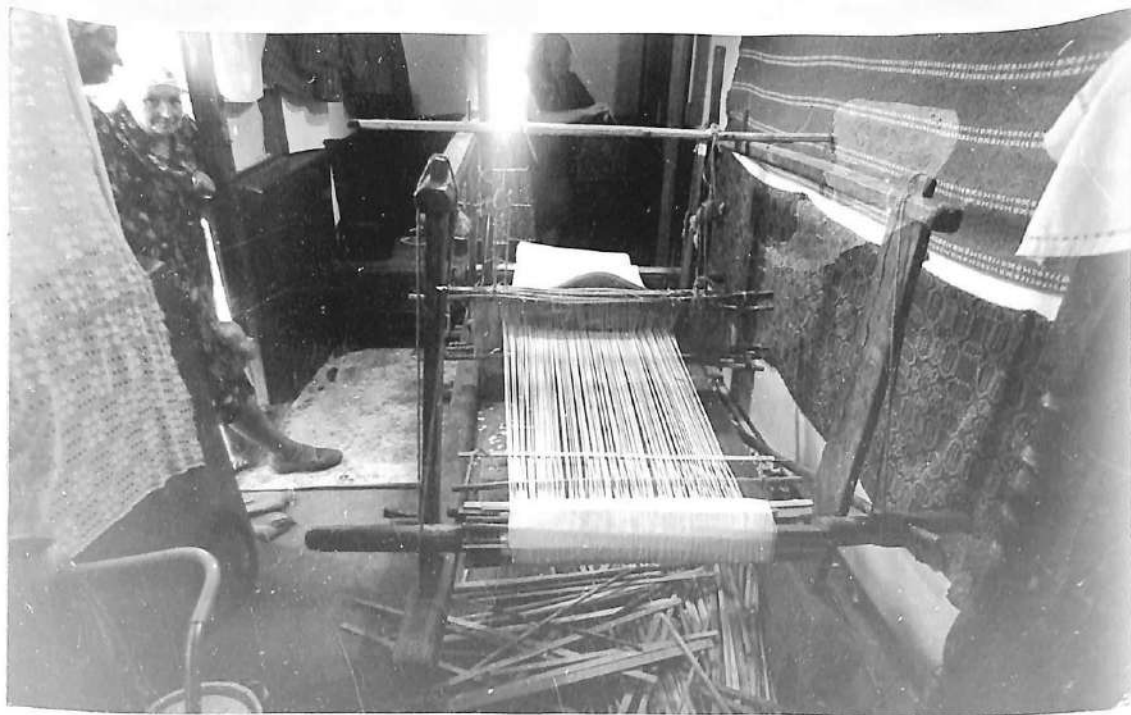
Заправленный горизонтальный ткацкий стан (на первом плане — задний вал).
